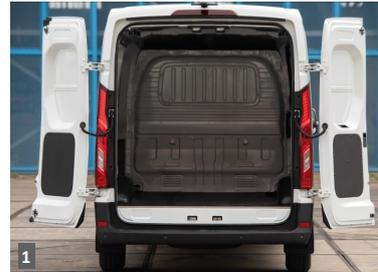
**1** Laderaumtüren mit 236 Grad Öffnungswinkel. Rückfahrkamera über der Tür montiert
