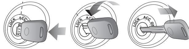
Pour retirer la clé du contacteur d'allumage, tournez-la dans le sens antihoraire afin de la positionner sur « ACC ». Enfoncez ensuite la clé vers le contacteur d'allumage et continuez de la tourner dans le sens antihoraire jusqu'à la position « LOCK » (VERROUILLAGE). La clé peut alors être retirée.
