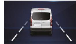
Si le véhicule est sur le point de sortir de sa voie, le système de détection de sortie de voie avertit le conducteur au moyen de signaux sonores et lumineux.
