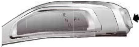
Wenn das Fahrzeug steht, drücken Sie die Taste für die Schaltstufe „P“ (1), um in die Schaltstufe „P“ zu schalten.
