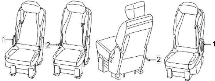
**Hinweis:** Der Hebel zur Verstellung des rechten Einzelsitzes befindet sich rechts vom Sitz, der Hebel zur Verstellung des linken Einzelsitzes befindet sich links vom Sitz und der Hebel zur Verstellung des mittleren Einzelsitzes befindet sich rechts vom Sitz.
