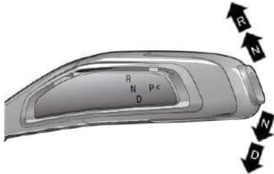
Betätigen Sie das Bremspedal und drücken oder ziehen Sie den Schalthebel kurz in die gewünschte Richtung (jeweils zwei Positionen zum Hoch- oder Herunterschalten). Nach dem Loslassen des Schalthebels kehrt der Schalthebel in die mittlere Position zurück.
