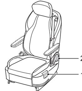
**Hinweis:** Der Hebel zur Verstellung des rechten Sitzes befindet sich rechts vom Sitz, während sich der Hebel zur Verstellung des linken Sitzes links vom Sitz befindet.
