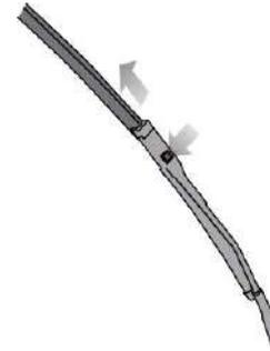
Stellen Sie den Schalter des Frontscheibenwischers auf die Wartungsfunktion ein, bevor Sie das Frontscheibenwischerblatt austauschen.
