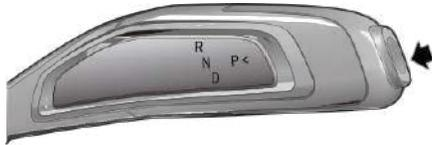
Wenn das Fahrzeug steht, drücken Sie die Taste für die Schaltstufe P (1). Das Fahrzeug wechselt in die Schaltstufe P.
