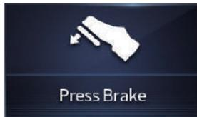
Das adaptive Geschwindigkeitsregelungssystem kann ca. 40 % der Bremsleistung der Fußbremse nutzen. Wenn das vorausfahrende Fahrzeug bei hoher Geschwindigkeit abrupt bremst, ist es der adaptiven Geschwindigkeitsregelung allein nicht möglich, das Fahrzeug auf eine sichere Geschwindigkeit zu verlangsamen. Hierbei wird im Kombiinstrument die Warnung „Brems betätigen“ angezeigt, und der Fahrer muss sofort reagieren.
