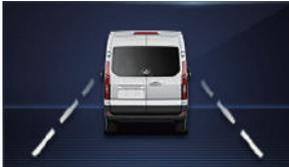
Die Fahrbahnmarkierungen auf der Displayschnittstelle des Infocenters im Kombiinstrument sind weiß und die „LCW-
