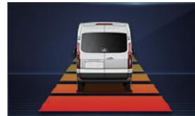
**Hinweis:** Wenn das Symbol für das vorausfahrende Fahrzeug angezeigt wird, ermöglicht die ACC Ihrem Fahrzeug, dem vorausfahrenden Fahrzeug in einem vorab eingestellten Zeitintervall zu folgen.
