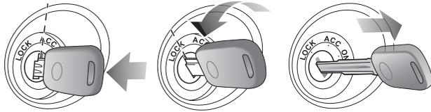
Um den Schlüssel aus dem Zündschloss zu ziehen, drehen Sie ihn gegen den Uhrzeigersinn auf „ACC“. Drücken Sie dann den Schlüssel in das Zündschloss und drehen den Schlüssel weiter gegen den Uhrzeigersinn auf „LOCK“. Jetzt lässt sich der Schlüssel abziehen.
